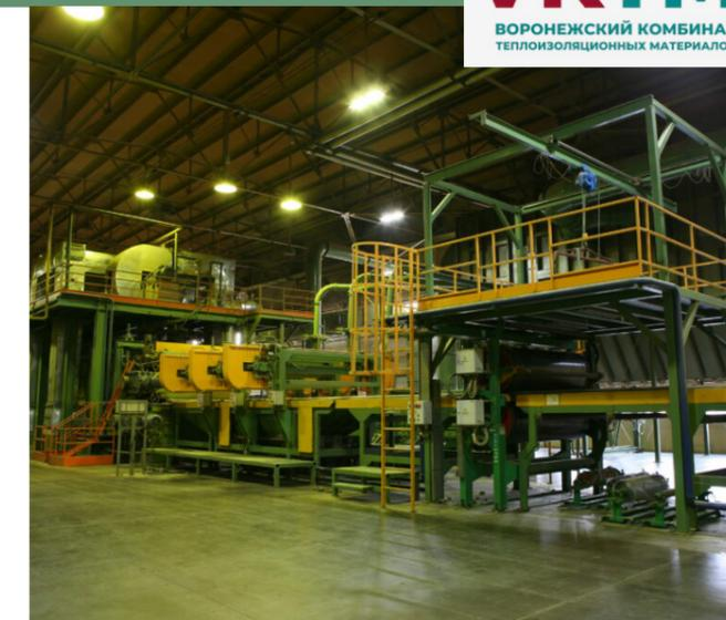
Производство минераловатных теплоизоляционных материалов на основе экологически чистого базальтового волокна с учетом высокоэффективных технологий и оборудования, апробированных и подтвердивших свою высокую результативность в рамках проекта организации строительства масштабного
